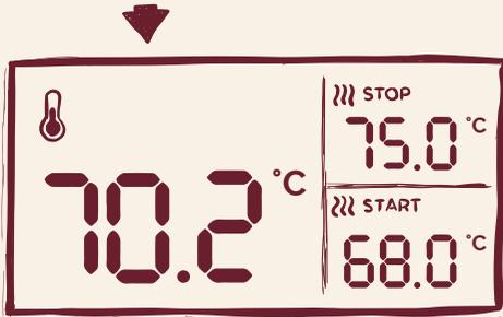
Maximal eingestellte Temperatur. Wenn die aktuelle Temperatur diesen Grenzwert überschreitet, schaltet die Spirale ab.
